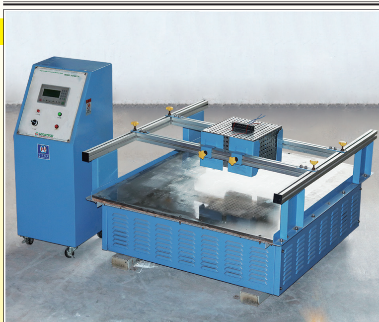
Equipo utilizado en los ensayos de resistencia a las vibraciones
