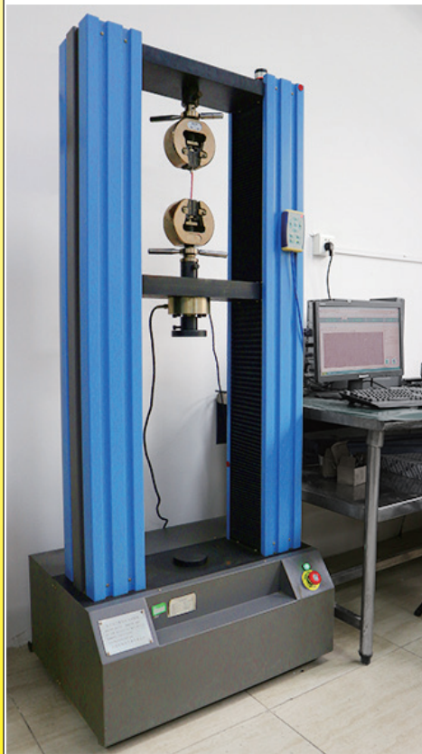
Banco de pruebas para ensayos de tracción
